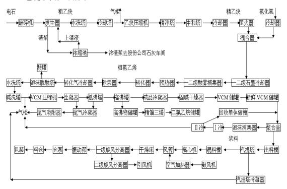
糊用聚氯乙烯采用微悬浮法生产工艺,在生产过程中将氯乙烯单体、油溶性引发剂、乳化剂、纯水等在分散系统中经充分分散、循环,使氯乙烯单体在乳化剂的保护下分散成含有定量引发剂的粒径约为 0.1-2 μm 的稳定液滴后再升温聚合的过程。该工
